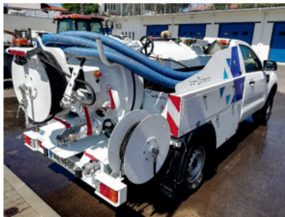
FOTO 2 - EQUIPAMENTO DE SANEAMENTO DE AR POR MEIOS MÓVEIS
